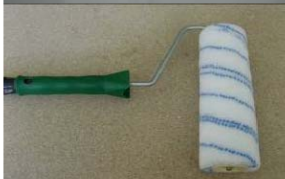
Váleček s krátkým vlasem (např. 14 mm pro roztírání materiálu).
