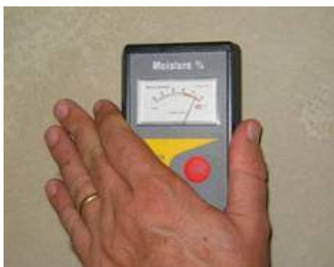
Měření vlhkosti podkladu Obsah vlhkosti < 4 % (hmot.) Např. měřicí přístroj Sika Tramex
