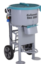
Míchačka s horizontálním oběhem Pro velká množství
