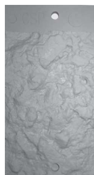
CSP-10 Ručně opracovaný povrch a následné obrokování
