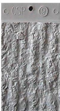
CSP-9: Silné frézování
