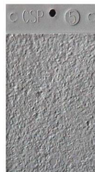
CSP-5: Středně brokované
