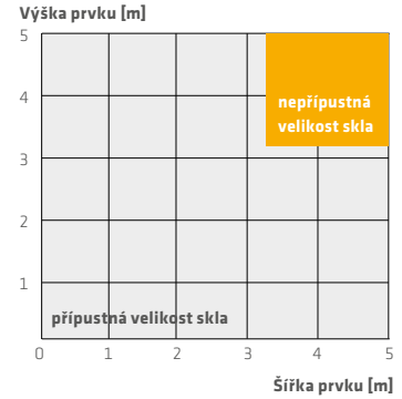
Obr. 3b: Za stejných podmínek jako na obr. 3a mohou být fasádní prvky s lepidlem Sikasil® SG-550 mnohem větší. A naopak výška spoje při stejné velikosti prvků může být o 30 % menší, celkový objem spoje dokonce o 60 %
