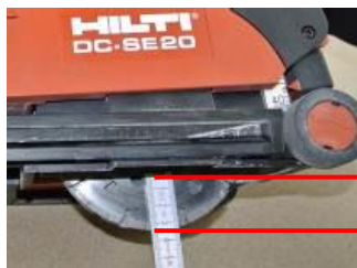
Řezačka spár musí být nastavena na hloubku 25 mm
