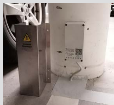
Obrázek 6. Instalace multisnímačů DuraMon do stávajícího betonu pomocí betonových jader vybavených snímačovým systémem DuraMon
