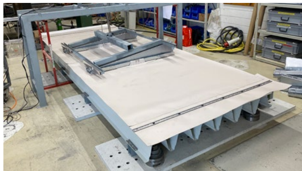
Mechanicky aplikované vzlakové zatížení na FV modul pomocí dvou úchytů SSM2.
