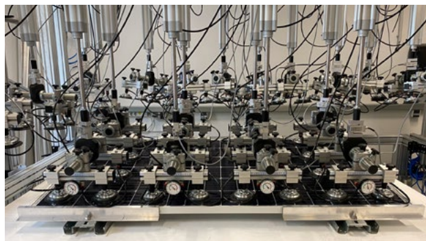
Zkouška vzlaku (uplift test) na SSM2 pomocí pneumatických válců.
