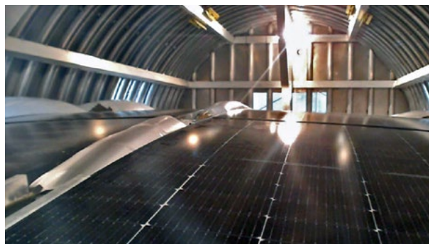
Zkouška vzlaku větrem u systému SSM2 orientovaného ve směru východ-západ.
