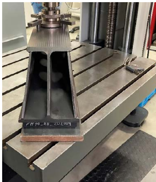
Test podkladnicového uložení kolejnice.
