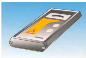
Měření vlhkosti podkladu Obsah vlhkosti < 4 % (hmot.) Např. měřicí přístroj Sika Tramex
