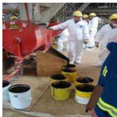
Zásobník a menší nádoby pro snadnější dávkování materiálu do násypky
