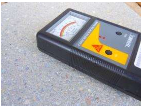
Použití přístroje Tramex pro měření vlhkosti podkladu
