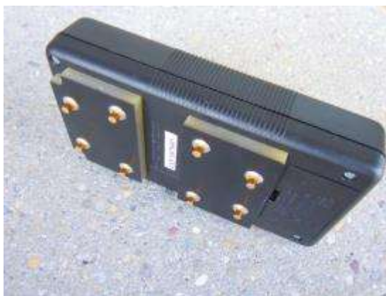
Kontaktní plochy na spodní straně přístroje, které musí být v kontaktu s podkladem
