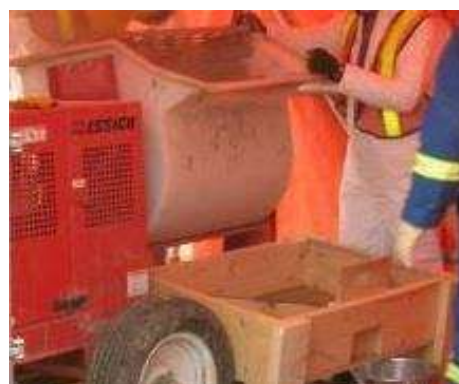
Zásobník 2. generace s uzavíratelným otvorem pro plnění menších nádob
