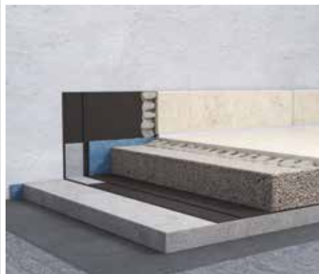
BALTERRA MSE DRAIN – pokládka keramických dlaždic na spřažený roznášecí potěr
