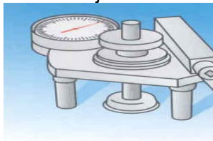
Zkouška podkladu Přídržnost > 1,5 N/mm 2 . Např. testovací zařízení Proceq, Dyna.
