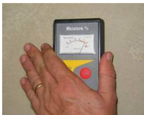
Měření vlhkosti podkladu Obsah vlhkosti < 4 % (hmot.) Např. měřicí přístroj Sika Tramex
