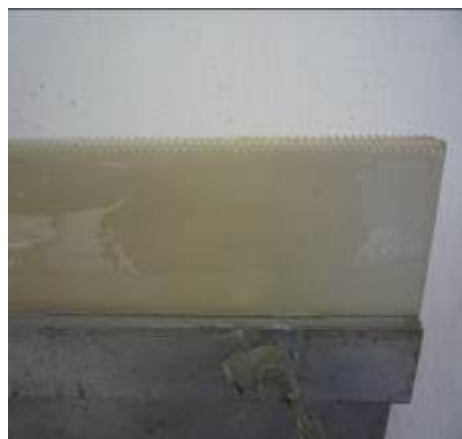
Gumová stěrka se zoubkovaným okrajem (1mm) např. PPW 59E01 (58cm) a hliníkový držák PPW 59 (58cm)
