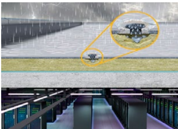
Mechanicky poškozená střešní hydroizolační fólie přijde do kontaktu s vodou.
