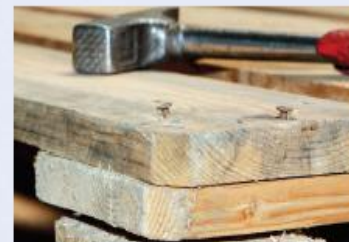
Zatlučení vyčnívajících spojovacích prvků
