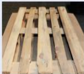
Nepřípustný konstrukční prvek, např. poddimenzovaný, ztrouchnivělý, oblina
