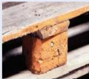
Znečištění, která by mohla být přenesena na náklad, např. barva, olej, zápach, plíseň, černé plísňové skvrny atd.
