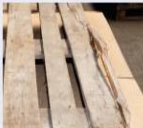
Napříč, částečně nebo zcela zlomená deska
