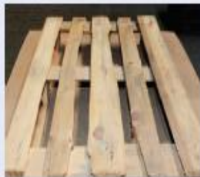
Nepřípustný konstrukční prvek, např. poddimenzovaný, ztrouchnivělý, oblina
