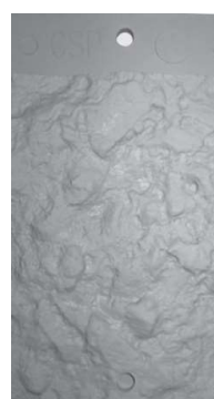
CSP-10 Ručně opracovaný povrch a následně obrokování
