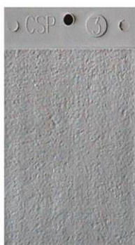
CSP-3: Lehce brokované
