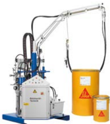
Nahoře: Aplikační stroj na dvousložkové tmely ze sudů a hoboků (aplikace v hale) Dole: Aplikace pistolí u jednosložkových tmelů z monoporce nebo kartuše (aplikace v terénu)
