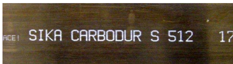
Obr. 8 Strana lamely s potiskem, na kterou se nenanáší lepidlo !
